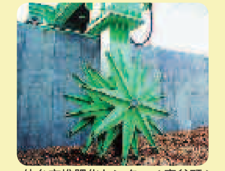
仙台市堆肥化センター(富谷町)パドル式攪拌装置
